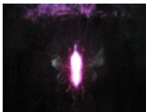
マイクロ波励起の液中気泡内プラズマの発光様相
